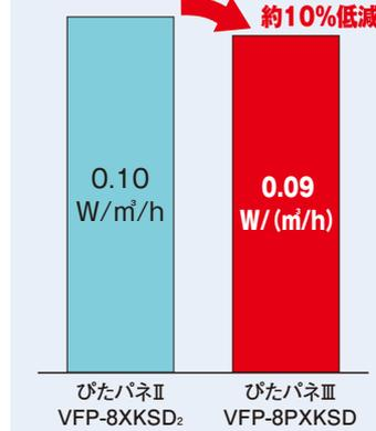
※弱ノッチ、50Hz、風量は標準フード組み合わせ時、消費電力は0Pa時
