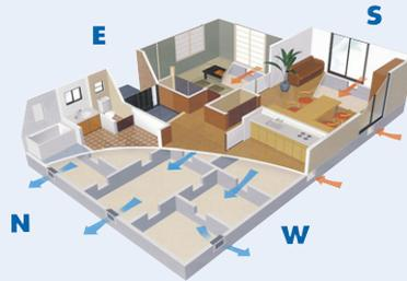
家屋の北側など3ヶ所に換気扇を設置して、床下の湿った空気を強制排出。南側などに設けた換気口から外気を取り入れ、床下の湿気を除去します。
