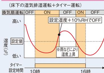
設定した開始時間と停止時間の間、設定した湿度値以下で運転します。
