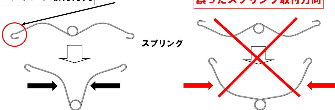
図の方向にスプリングを曲げます
