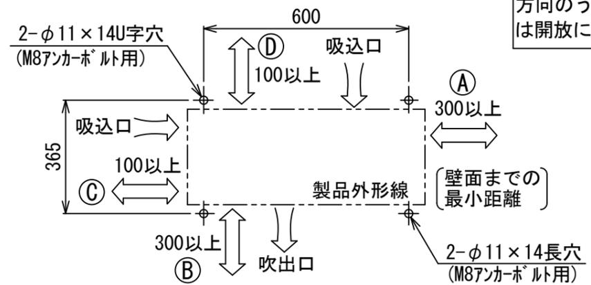
ヒートポンプユニットの据え付けは、**(A)(B)(C)(D)**方向のうち少なくとも2方向は開放にしてください。
