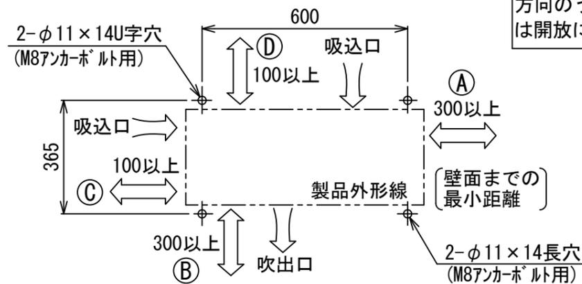
ヒートポンプユニットの据え付けは、(A)(B)(C)(D)方向のうち少なくとも2方向は開放にしてください。
