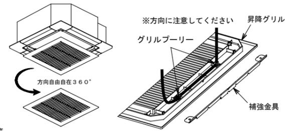
昇降グリルを90°回転させるときは必ず昇降グリル内側のグリルブリーと補強金具を回転方向に付けかえてください。
