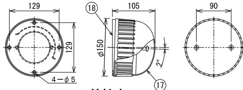
取付寸法詳細図 (取付板取付寸法図) 正面より見る
