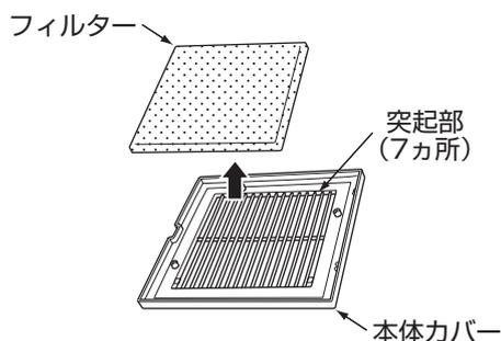
3. フィルターは左右を引張るようにして、本体カバー内側の突起部7カ所にフィルターを差し込んで取り付けます。
