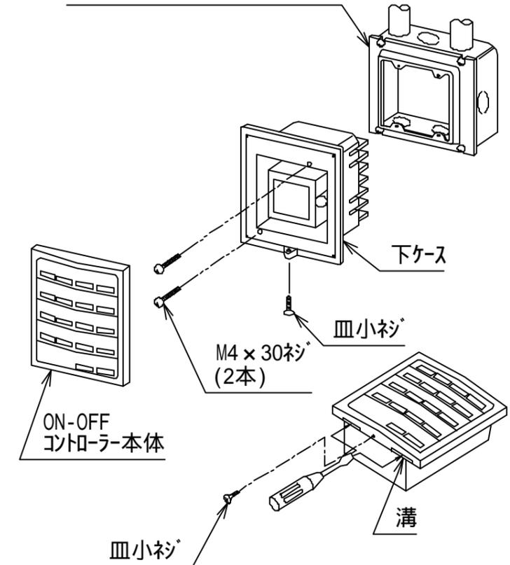
ON-OFFコントローラの下側にある皿小ネジを外し、コントローラ本体下側の溝にマキストライバ等を入れてこじりこじりして、下ケースを外してください。ON-OFFコントローラ配線を、コントローラ本体の端子台に接続してください。ON-OFFコントローラ下ケースを付属のM4ネジ(2本)を使用して固定します。ON-OFFコントローラ本体を下ケースのツマに合わせ、はめ込み、取り付けてください。皿小ネジを取り付けてください。
