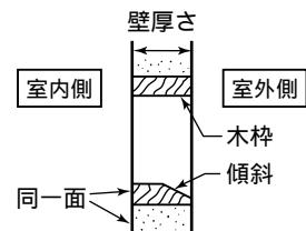
上図の寸法に合わせて木枠を作り、木枠を壁に確実に固定します。
