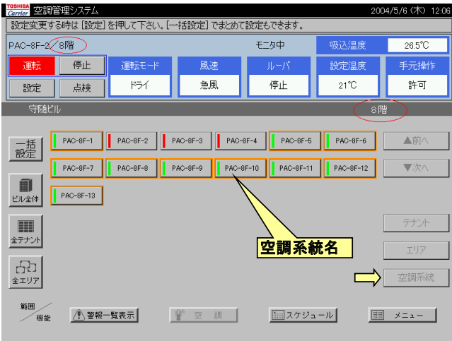
(D) 空調系統別監視画面 (空調系統単位の運転状態を表示)
