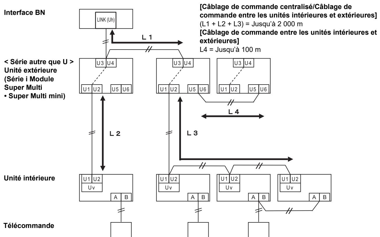
**Lors de la connexion à un modèle antérieur de climatiseur commerciale légère, échange de chaleur air/air, pompe à chaleur air/eau ou interface de commande d'un équipement à usage général**
