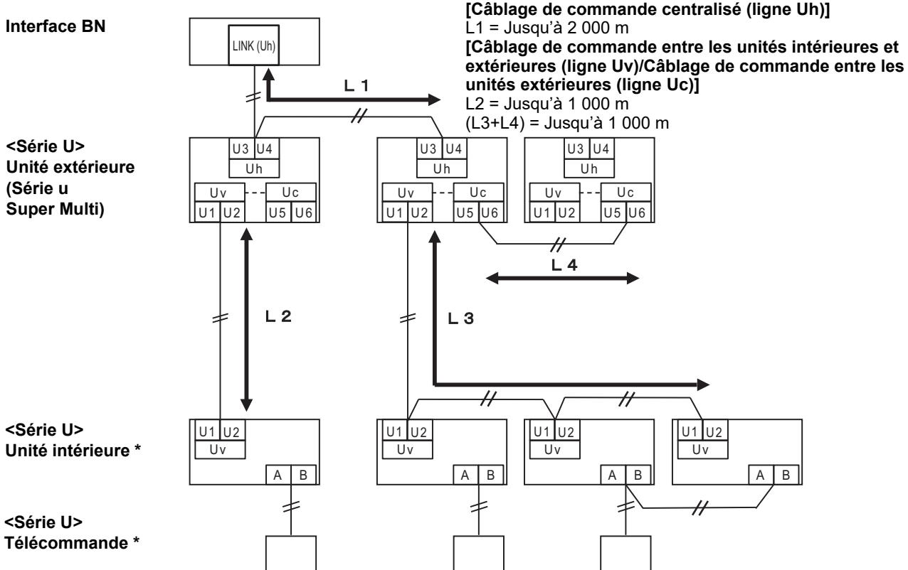
\* Les spécifications du câblage dans le schéma du système ci-dessus sont les mêmes, même si l'unité intérieure ou la télécommande n'appartiennent pas à la série U.
