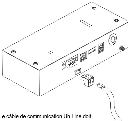
Le câble de communication Uh Line doit être mis à la terre sur le climatiseur. Ne raccordez pas le blindage du câble au connecteur. Il doit être ouvert et isolé.
