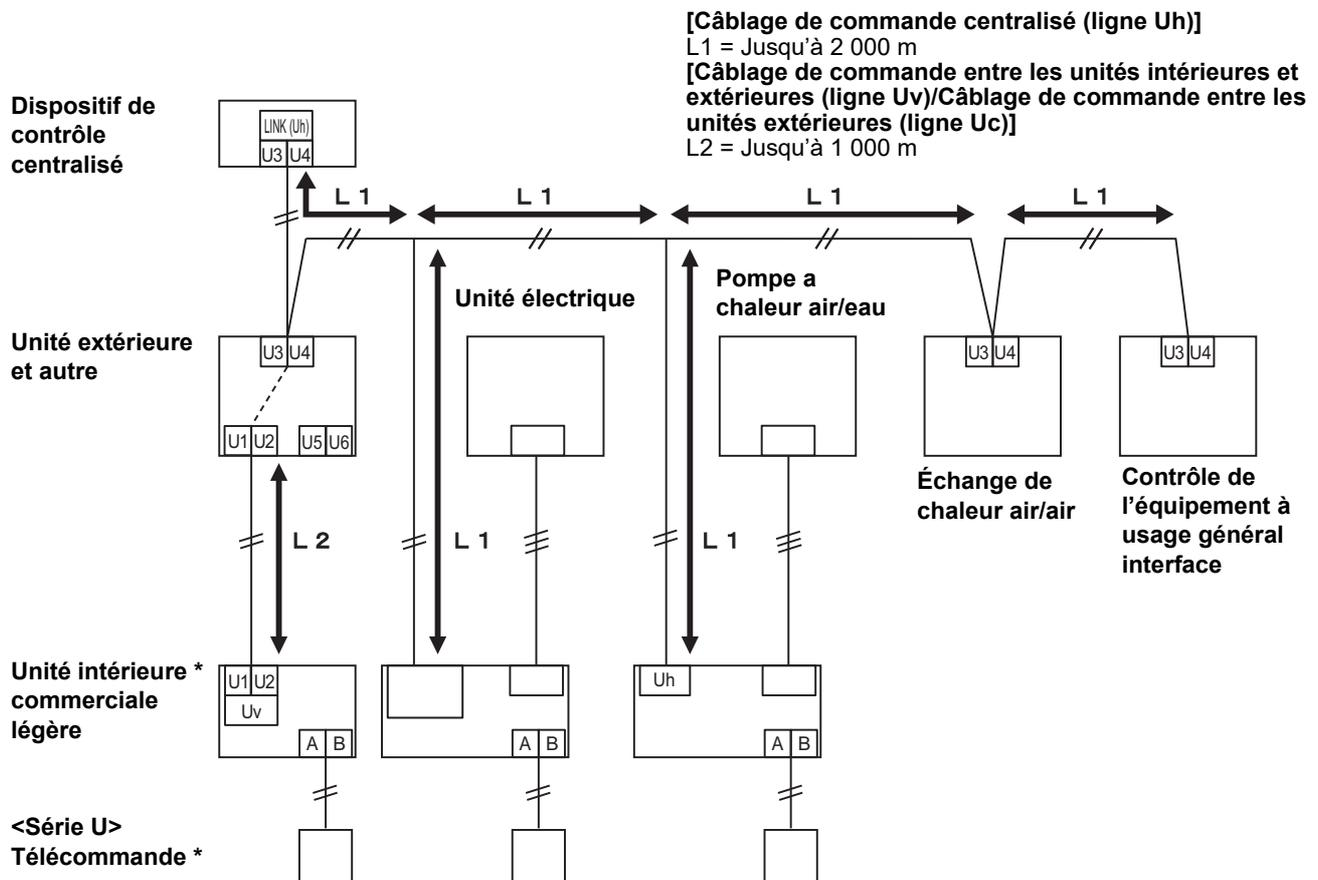
\* Les spécifications du câblage dans le schéma du système ci-dessus sont les mêmes, même si l'unité intérieure ou la télécommande n'appartiennent pas à la série U.
