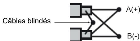
Les câbles blindés doivent être sertis avec des connecteurs à extrémité fermée pour les interfaces avec une adresse différente de 1 et les extrémités des câbles blindés ne doivent pas être isolées.
