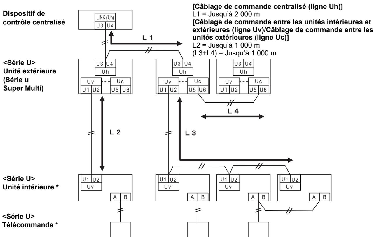
\* Les spécifications du câblage dans le schéma du système ci-dessus sont les mêmes, même si l'unité intérieure ou la télécommande n'appartient pas à la série U.
