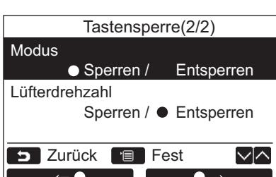
**1** Drücken Sie die [ ⌈ ⌉]/[ ⌋ ⌑]-Taste zur Auswahl von „5. Tastensperre“ auf dem „Anfangseinstellungen“-Bildschirm und drücken Sie dann die „Einst.“ [ F2]-Taste.
