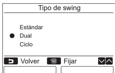
**1** Pulse el botón [ ] / [ ] para seleccionar “3.Configuración de la lama” en la pantalla de menú y, a continuación, pulse el botón “ Validar” [ F2].
