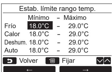
**1** Pulse el botón [↑ ↓] / [← →] para seleccionar “2. Estab. límite rango temp.” en la pantalla “Ahorro de energía” y , a continuación, pulse el botón “Validar” [F2 F2].
