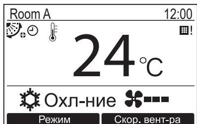
Выполните чистку воздушного фильтра, если на экране с подробной индикацией отобразится “! ” (значок фильтра). (стр. 26) (“! ” не отображается в режиме обычной индикации.)
