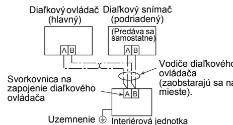
Obsluha skupinového ovládania viacerých interiérových jednotiek z diaľkovým ovládačom nainštalovaných na dvoch rôznych miestach.
