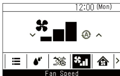
**1** Drücken Sie [◀] und [▶], um zum „Lüfterdrehzahl (Fan speed)“-Bildschirm zu wechseln
