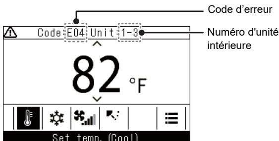
Lorsqu'une erreur survient dans le climatiseur, le code d'erreur et le numéro de l'unité intérieure clignotent sur l'affichage de la télécommande.
