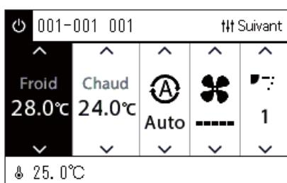
Avec les réglages du point de réglage double, vous pouvez régler des températures de consigne individuelles pour les opérations « Froid (Cool) » et « Chauffage (Heat) » pour régler la température intérieure.
