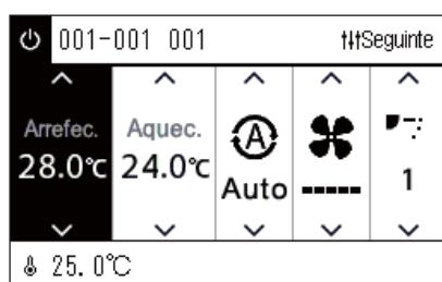
Com as definições dos pontos de definição duplos, pode definir as definições de temperatura individuais para as operações “Arrefec. (Cool)” e “Aquec. (Heat)” para ajustar a temperatura interior.
