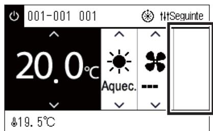
Um espaço em branco é exibido se houver uma função cujas configurações não podem ser alteradas.
