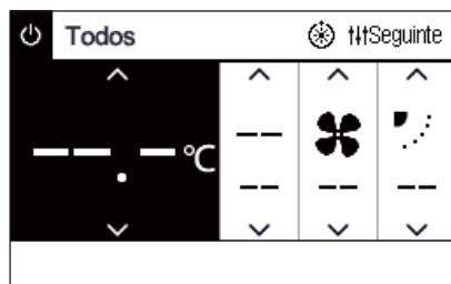
Exibido quando as configurações do aparelho de ar condicionado não coincidem.
