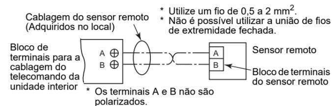
**NOTA 1:** O fio do sensor remoto não deve ser agrupado com outros fios (cabo de alimentação, etc.), nem instalado com outros fios na mesma conduta, pois isso pode causar um mau funcionamento.
