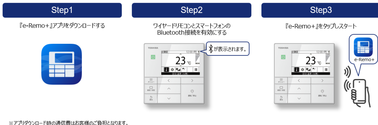
図7: 専用アプリ e-Remo+(イーリモプラス) 注2 とワイヤードリモコンの接続イメージ
