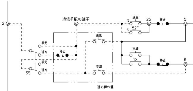
注) 端子番号#2-送風スイッチ用端子#3と52Fのa接端子#3間のジャンパ線を外し、端子を現場で手配してください。
