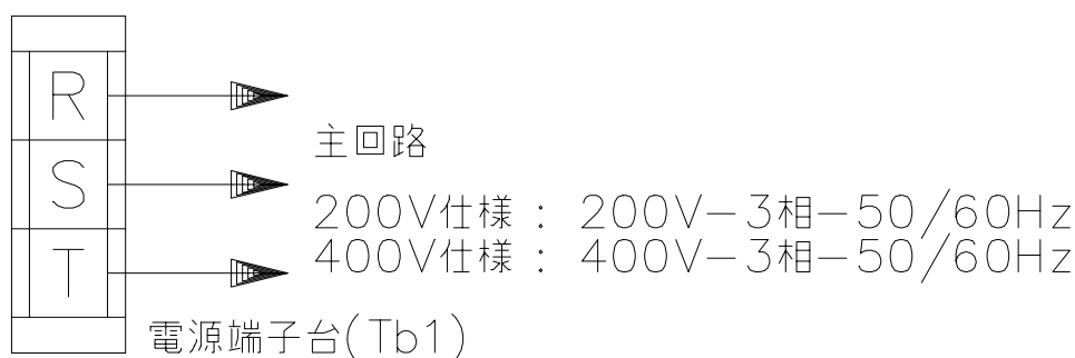
図-7 電源の接続
