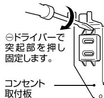
②ドライバーで突起部を押し固定します。
