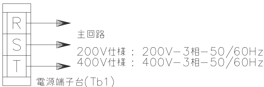
図-6 電源の接続
