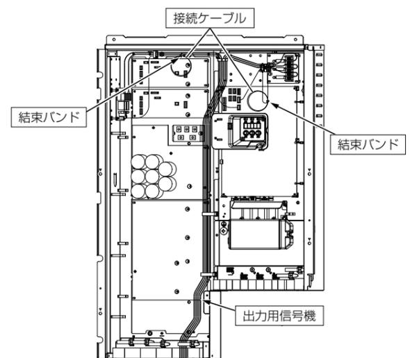
ケーブルストラップ、ワイヤークリップを上図位置に取付け、付属接続ケーブル・出力用信号線を結束してください。
