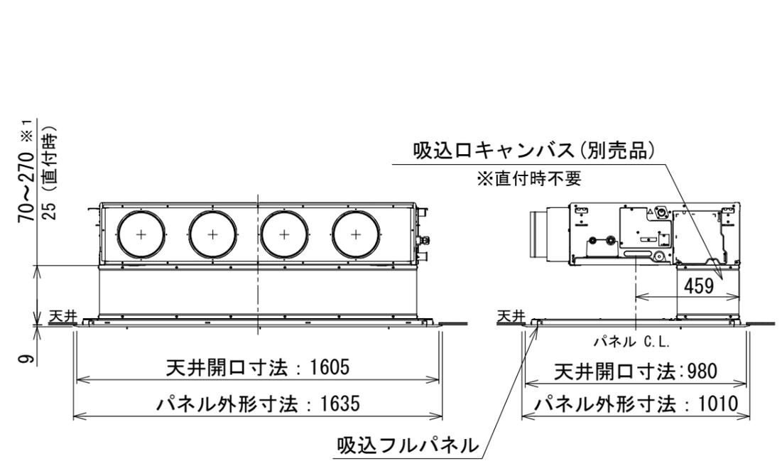
※1) 吸込口キャンバスを縮めて70~170mmの範囲で使用する場合は、キャンバスの圧損を30Pa見込んでください。
