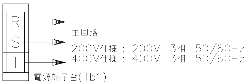
図-7 電源の接続
