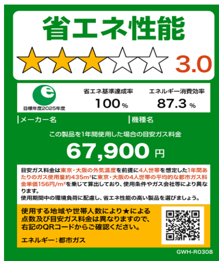
ガス給湯器(都市ガス)の例
