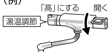
■ サーマスタットタイプ 湯温調節を「高」にして開く。
