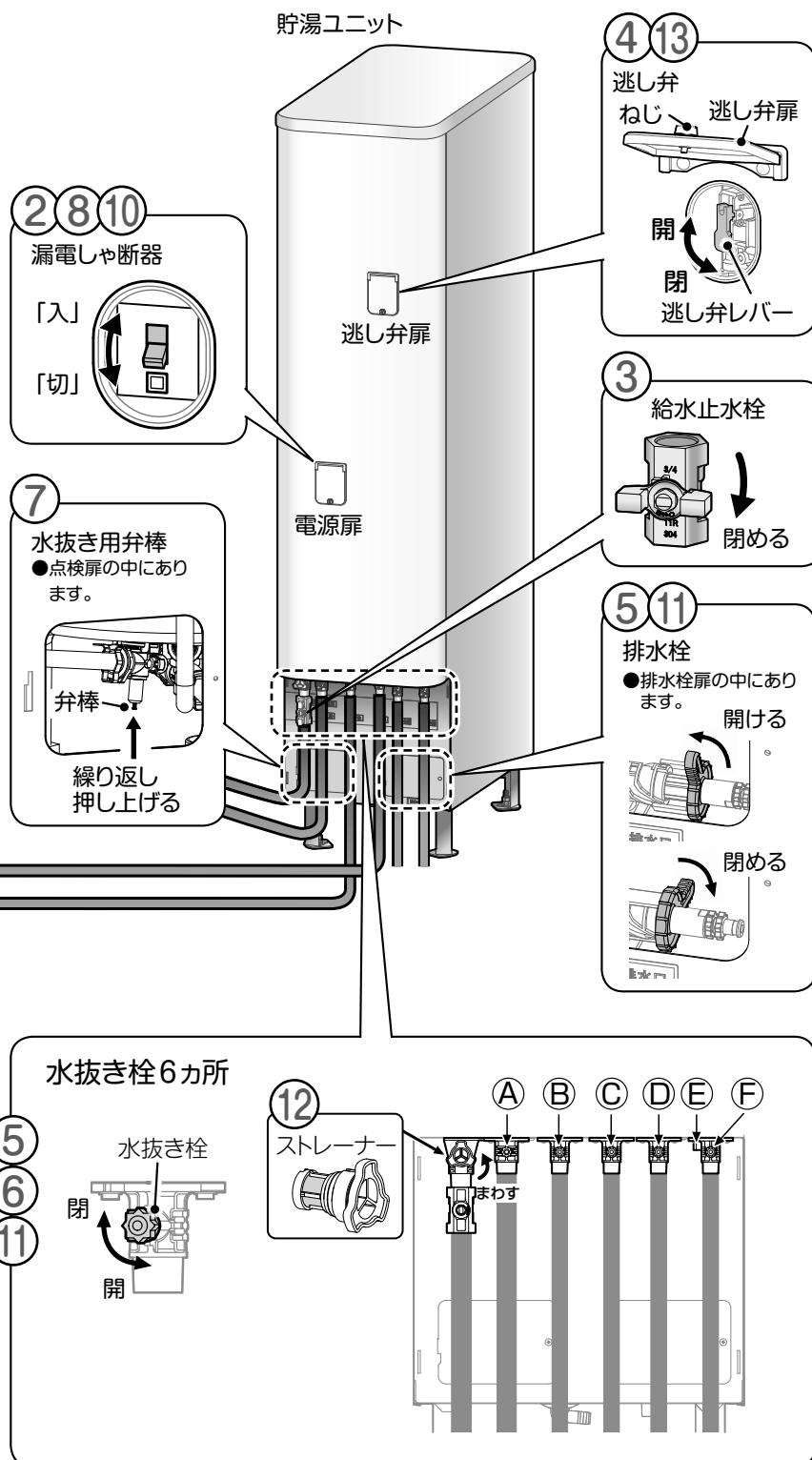
**7** 点検扉を開け、水抜き用弁棒を指で押し上げる
