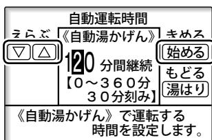
自動湯かけんの運転時間は、手順2で【自動運転時間】を選択して表示された画面で設定します。
