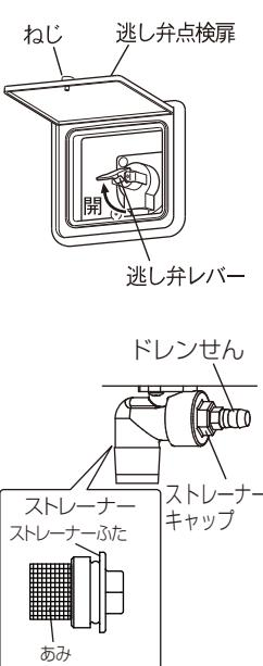
**5** 貯湯タンクユニット下部にある給水口のストレーナーをはずし、あみを掃除します。(ドレンせんをゆるめ、配管内に残っている水を抜きます。※モンキーレンチ等でストレーナーキャップをはずし、水を流しながらブラシ等でよく洗います。)
