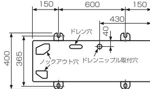
アンカーボルトの出し寸は15mm以下にしてください。
