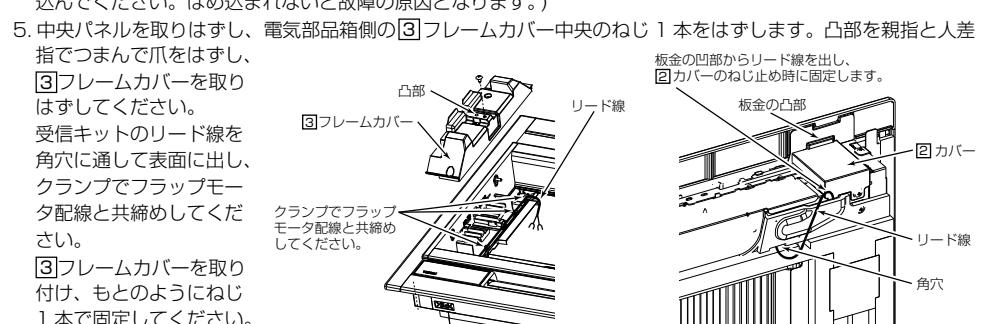
5. 中央パネルを取りはずし、電気部品箱側の③フレームカバー中央のねじ1本をはずします。凸部を親指と人差指でつまんで爪をはずし、③フレームカバーを取りはずしてください。
