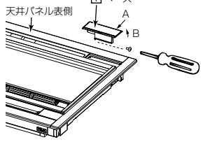
3. 受信キットのリード線を②カバーをはずした穴に通します。図のように受信キットを斜めに傾け、C部の角を付き合わせながらⒶの矢印の方向に入れ込みます。次にD部を回転させながらE部を引掛けて、天井パネルと水平になったところで両手ではさみFの方向に押し込んでください。
