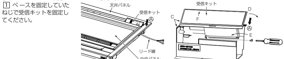
4. 天井パネルの裏面に②カバーを取り付け、リード線を板金の凹部と②カバーの間より引き出した後(下図参照)に、ねじ1本でもとのように固定してください。(②カバーは板金の凸部にはめ込んで、はずれないように組み込んでください。)はめ込まれないと故障の原因となります。
