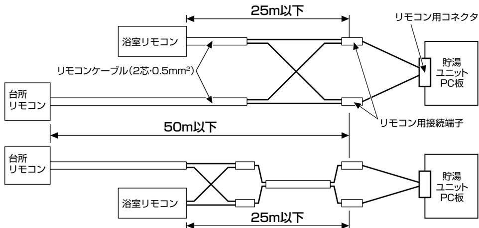
**1** リモコンケーブルをリモコン用配線取入口から貯湯ユニット内に引き込み、電気部品箱下部の引き込み穴から電気部品箱内に引き込みます。
