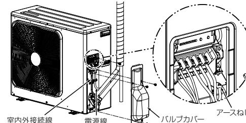
※電源線と室内外接続線は下記皮ムキ長さを守つて必ず二重被覆部分をコードクランプでしっかりと固定してください。
