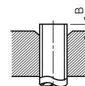
※従来のフレアツールを使ってR410A用のフレア加工をする場合は、R22のときより約0.5mm多めに出せば規定のフレア寸法に加工できます。出し代の寸法調整は銅管ゲージを使用すると便利です。
