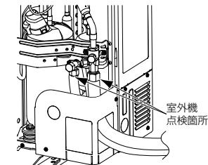
機器設置後、冷媒が漏えいしていないことを工事業者(漏えい点検資格者)が確認し、漏えい点検記録簿に所用事項を記入してください。
