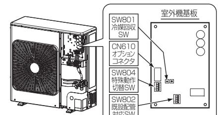
制御基板上は通電されていますので、感電に注意してください。
