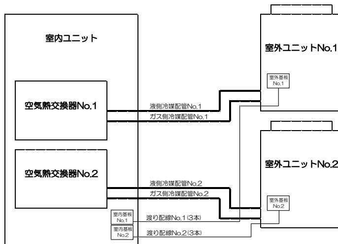
注：室内基板と室外基板の渡り配線及び冷媒配管の接続が正しく行なわれていない場合、正常な運転を行なうことができません。
