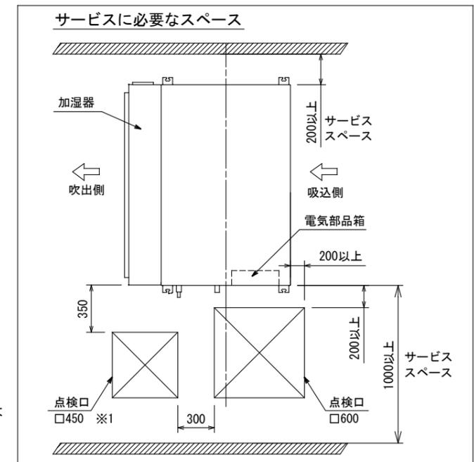
※1 気化式加湿器を取り付ける場合は点検口を設置してください。
