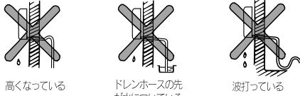
●配管が完了したら、ドレン皿へ水を入れて排水が確実にできることを確認してください。
