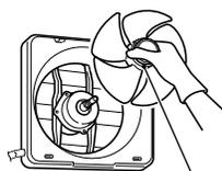
ボタンを押さずに「カチッ」と音がするまで押し込みます。「カチッ」と音がしないときは、羽根を少し引き出し、もう一度押し込みます。「カチッ」と音がすることを必ず確認してください。
