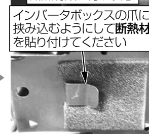
断熱材貼り付け状態
