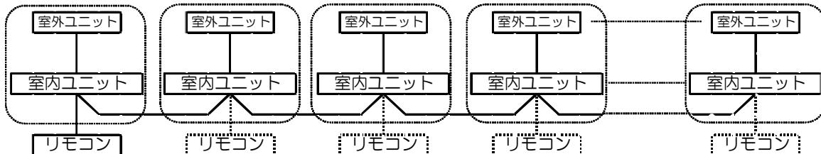
室内ユニット：室外ユニットに1：1以外のものを含むシステムの場合(室外ユニット合計最大8台まで)
