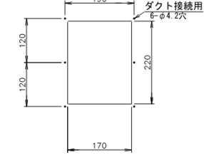
外気取入口ダクト接続口(右側面図)
