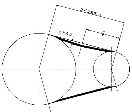
表-4 たわみと適正たわみ荷重(標準プーリ、標準ベルト使用時)
