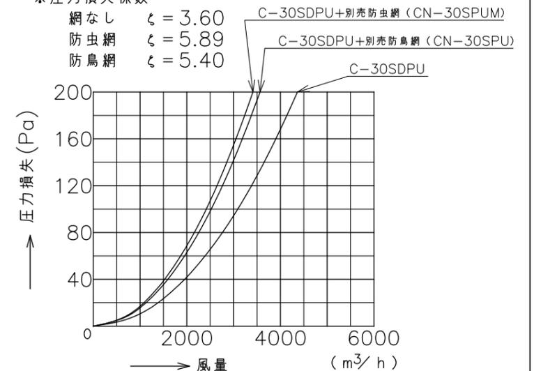
■ 圧力損失曲線：給気
