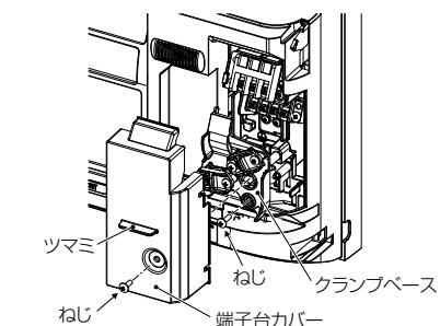
3. リモコン線は、リモコン・集中コントロール配線用端子台のⒶⒷ端子に挿入し、ねじ止めします。
