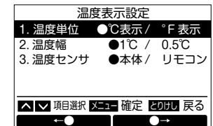
温度センサでリモコンを選択すると、詳細表示画面に「R」が表示されます。ただし、子リモコンに設定されている場合は表示されません。
