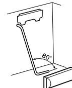
冷媒配管用座屈防止材を使用する場合は削り粉が入らないよう必ずフレア加工を行ったあとに挿入してください。
