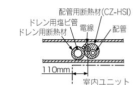
このエアコンは背面に付いた露をドレンパンに集めて排水する構造になっていますので、極め上方に電源コードなどを収納しないでください。
