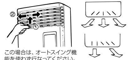
吹出フラップは5枚運動して8段階に変更できます。角度を変更するときは、吹出フラップの中央付近を持ち、ゆっくりと動かしてください。
