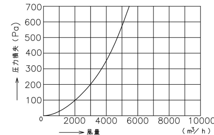
■ 圧力損失曲線：給気
