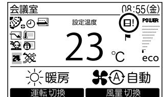
●フィルターチェックマークが表示されているときにエアコンを運転すると、「フィルターの清掃時期になりました。フィルターの清掃を行って下さい。」が表示されます。表示中に操作ボタンを押すか、5秒以上放置すると表示は消えます。
